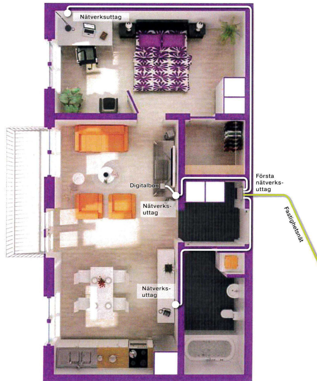
Så här kan det se ut i en lägenhet där det finns fiber indraget. Anslutningen till fastighetsnätet sitter i hallen, och därifrån är ethernet-kablar dragna för bredband, tv och telefoni.
